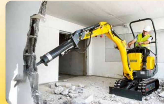
NE6 auf 803 Das optimale Gespann für Abbruch- und Renovierungsarbeiten in Innenräumen. Selbstverständlich mit allen technischen Features der großen Modelle.
