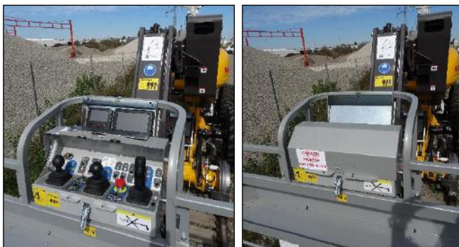
Bedienung im Korb mit Rückfahrmonitor und Leistungsdatenanzeiger
